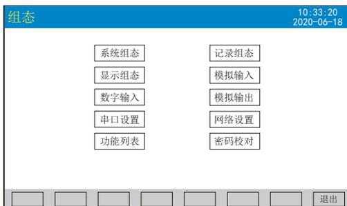
进入组态首先要进行密码校对，点击“密码校对”将出现一对话框，在对话框输入密码（对话框操作可参见第24页“六、T6输入法”一节）。密码由6位数据组成，出厂默认密码为000000，用户可以在“系统组态”——“用户密码”一栏修改校对密码。若密码输入错误，用户将不能进入各组态画面。
