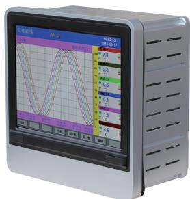
OHR-K700系列触摸式数据采集控制工作站采用新型大规模集成电路，对输入、输出、电源、信号采取可靠保护和强抗干扰设计。70路万能信号输入（可组态选择输入：标准电压、标准电流、热电偶、热电阻、毫伏等）。可带20限报警输出，14路变送输出，6路DI输入，RS232/485通讯接口，以太网接口，微型打印机接口和USB接口，SD卡插座；可提供传感器配电；具有强大的显示功能，实时曲线显示，历史曲线追忆，棒图显示，报警状态显示。
