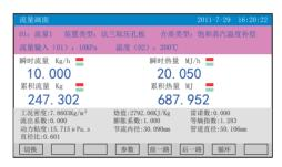
流量画面:将流量回路里的流量、温度 、压力信息以组合的方式显示在同一画 面上,同时显示各参数信息
